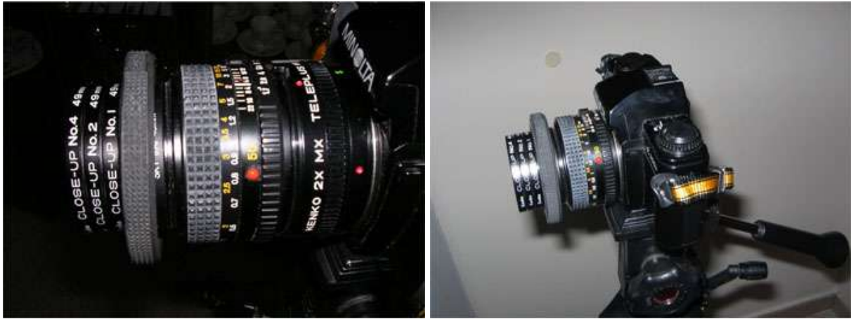
fig. 2: el empleo de las lentes adicionales; el sistema más económico por la macrofotografía
