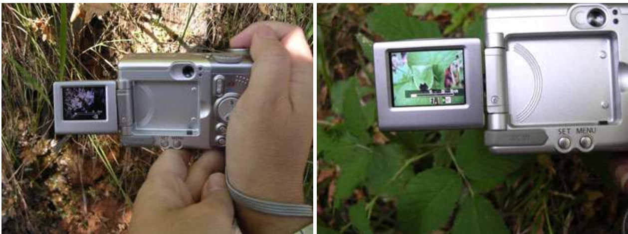
fig. 4 : un optional molto valido per la foto macro; lo schermo LCD orientabile
