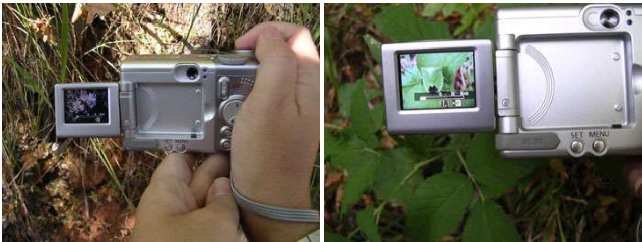
fig. 4: un optional muy válido por la foto macro; la pantalla LCD orientable
