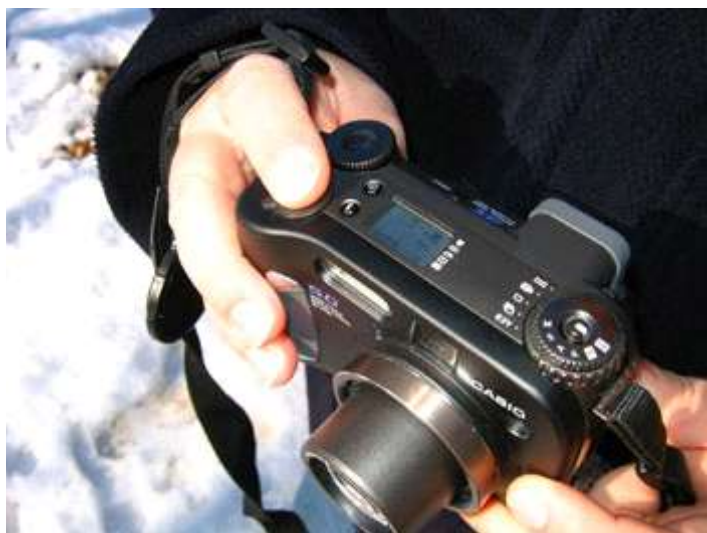
fig.4 : il dispositivo di blocco della messa a fuoco permette di bypassare i problemi dovuti all’autofocus
