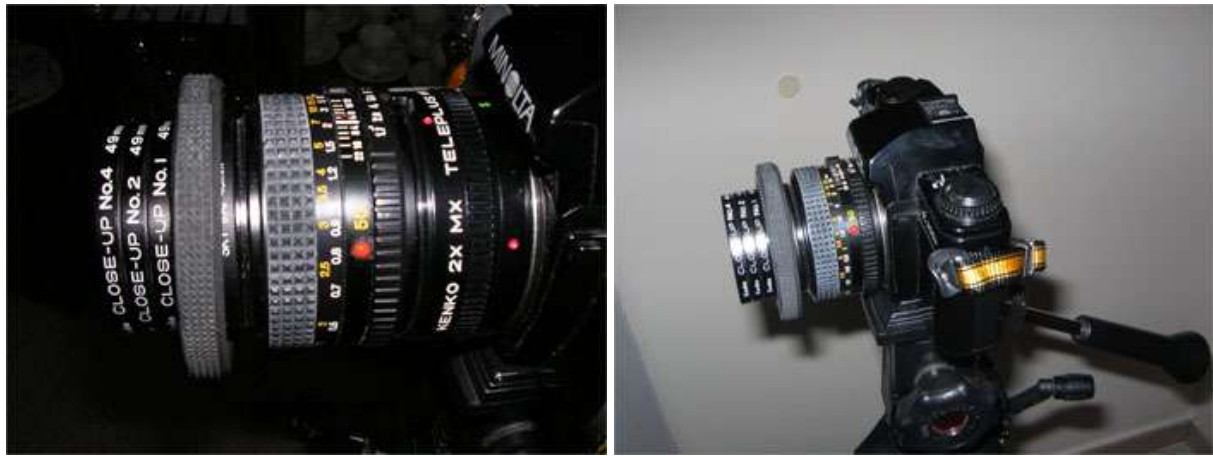
fig. 2: l'uso delle lenti aggiuntive; il sistema più economico per la macrofotografia
